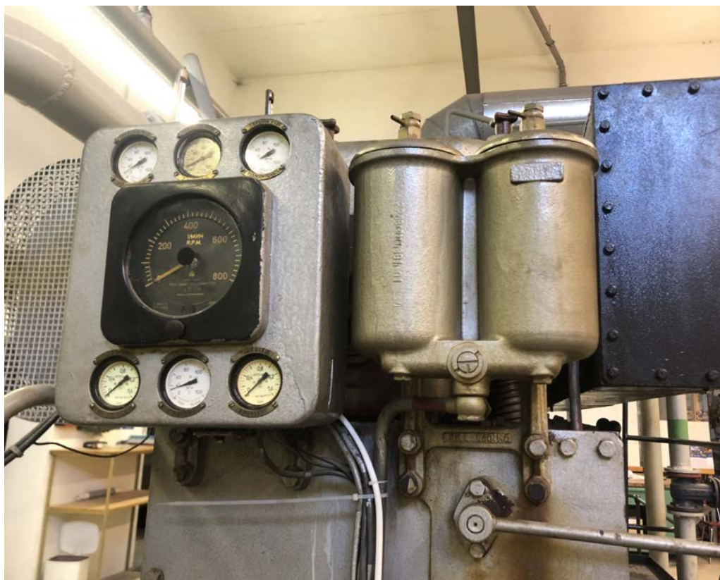
"Přístrojový panel" HAR II - otáčkoměr, tlakoměry a teploměry | Foto: Ing. Veronika Dubská
